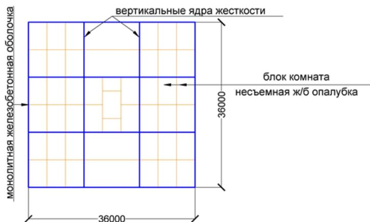
Схема железобетонного каркаса по технологии блок-комнатной опалубки
