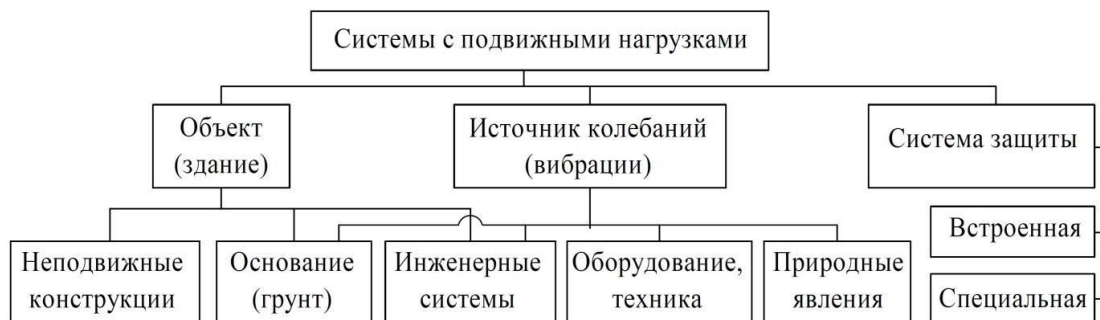
Рис. 1. Структура систем с подвижными нагрузками и защитой от вибраций
