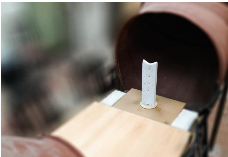
Рис. 5. Макет здания в аэродинамической трубе
