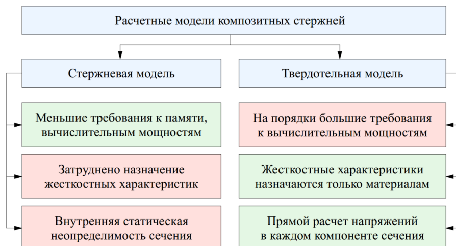
Рис. 1. Преимущества (зеленый) и недостатки (красный) стержневых и твердотельных расчетных моделей композитных конструкций
