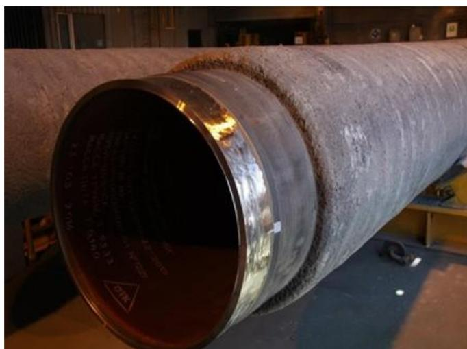
Рис. 6. Бетонное покрытие, сформированное методом набрызга
