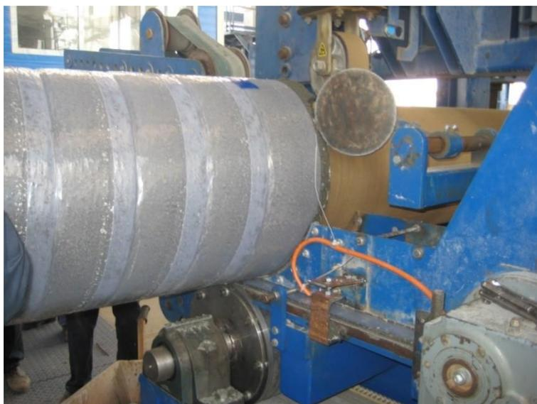
Рис. 4. Нанесение сплошного бетонного покрытия методом набивки
