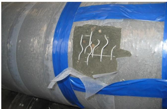
Рис. 5. Оголение арматурной сетки бетонного покрытия
