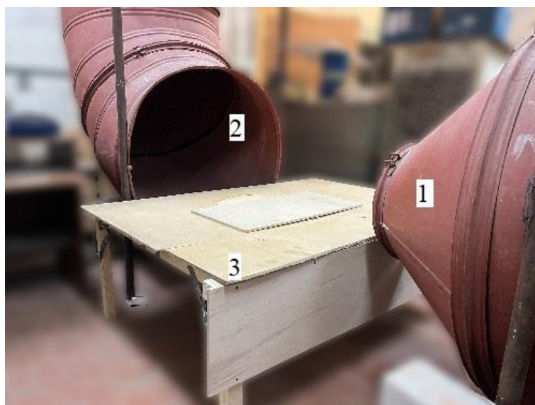
Рис. 1. Аэродинамическая труба малого диаметра: 1 – выходное сечение; 2 – входное сечение; 3 – подмакетник
