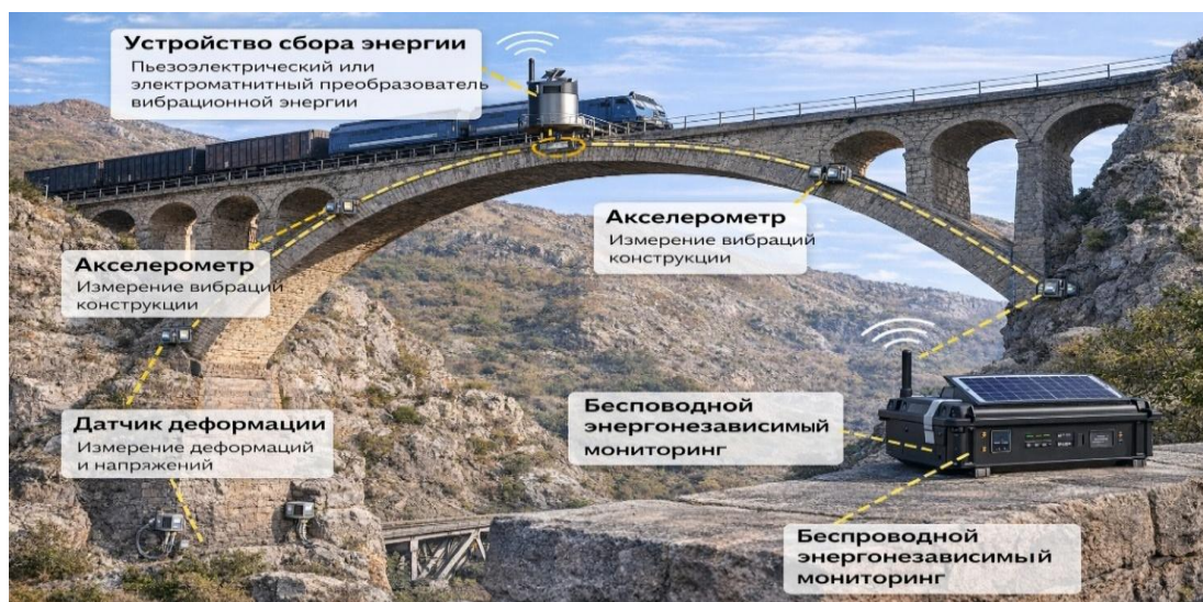
Рис. 7. Оптимальное размещение датчиков и устройств сбора энергии
