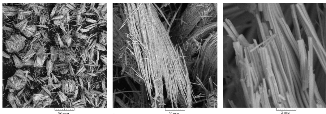
Рис. 1. СЭМ изображение нитевидных кристаллов гептамолибдата тетракус (2-аминийэтанол)диаммония (NH_4)_2(NH_3CH_2CH_2OH)_4[Mo_7O_{24}]
