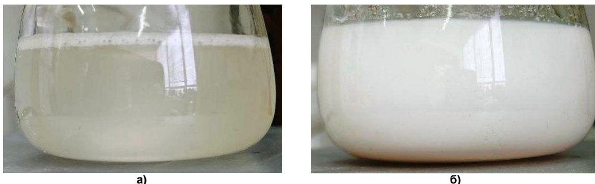
Рис. 2. Фото исходной смеси компонентов (а), смеси после образования привитого сополимера (б)
