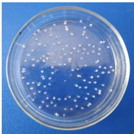
Рис. 1. Гранулы композитного фотокатализатора
