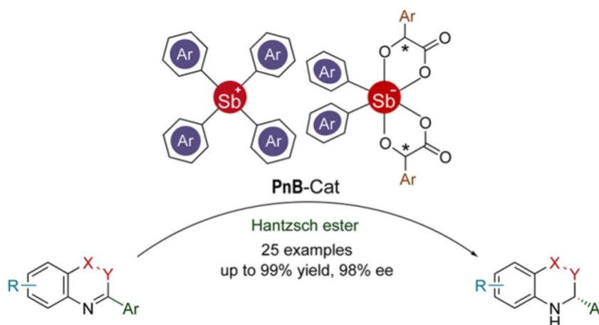
Ряд хиральных катализаторов пниктогена может быть быстро получен из триарилстибина с легкодоступными аналогами миндальной кислоты, и катализатор демонстрирует замечательную эффективность энантиоконтроля даже при загрузке 0,05 мол. %. Кроме того, свойства катализатора и понимание механизма были исследованы с помощью исследований нелинейных эффектов и  $^1\text{H}$  ЯМР.
