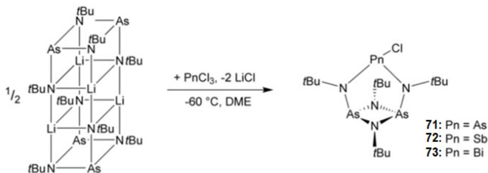
Литирование (*бис*-амидо)диазадиарсетидина  $(t\text{BuNAs})_2(t\text{BuNH})_2$  в алифатических растворителях приводит к димерным металлизированным частицам  $[(t\text{BuNAs})_2(t\text{BuNLi})_2]_2$ . При взаимодействии с  $\text{AsCl}_3$ ,  $\text{SbCl}_3$  и  $\text{BiCl}_3$  могут быть получены полициклические соединения  $[(t\text{BuNAs})_2(t\text{BuN})_2]\text{PnCl}$  ( $\text{Pn} = \text{As}, \text{Sb}, \text{Bi}$ ).
