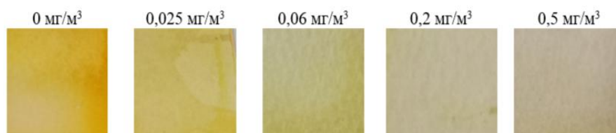
Рис. 3. Изменение окраски бумажного колориметрического сенсора в течение 1 ч воздействия формальдегида
