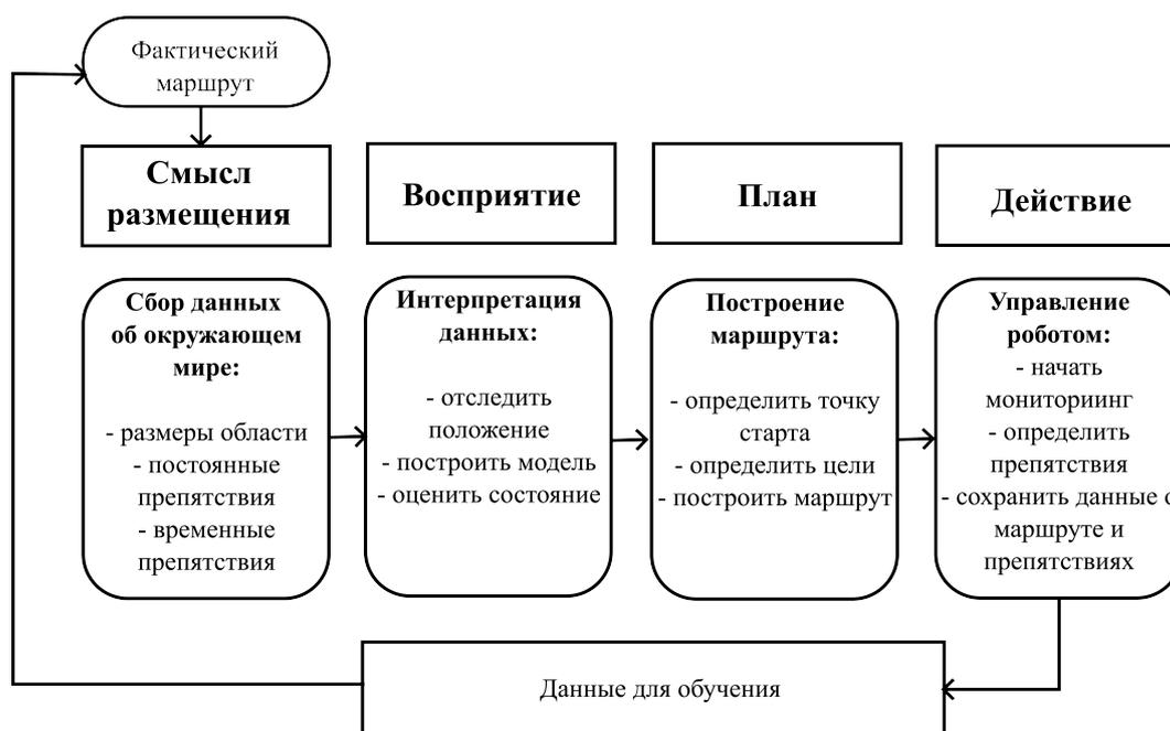
Рис. 7. Технологический цикл работы системы мониторинга
