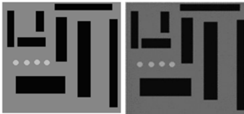
а. изображение модели объекта исследования б. реконструированное томографическое изображение модели
