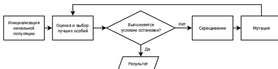
Рис. 1. Схема работы алгоритмов эволюционного моделирования
