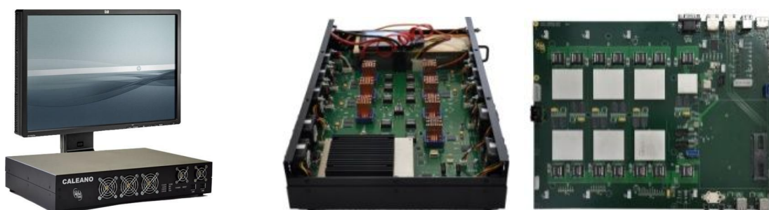
а) общий вид РВБ «Калеано» б) РВБ «Калеано» со снятой верхней крышкой и печатная плата
