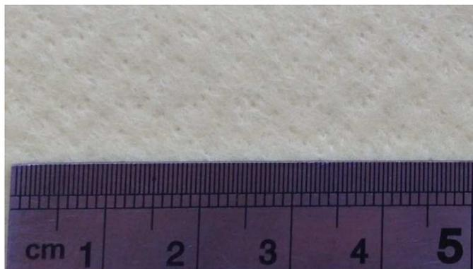
**Рис. 2.** Фотография поверхности войлочного материала (Twaron® felt #9)
