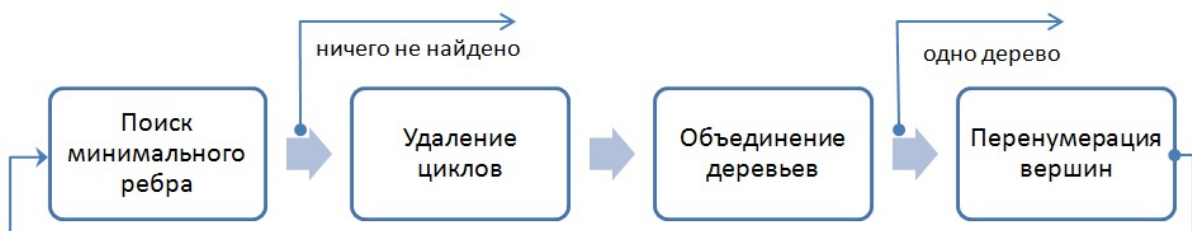
Рис. 4. Схема работы алгоритма Борувки
