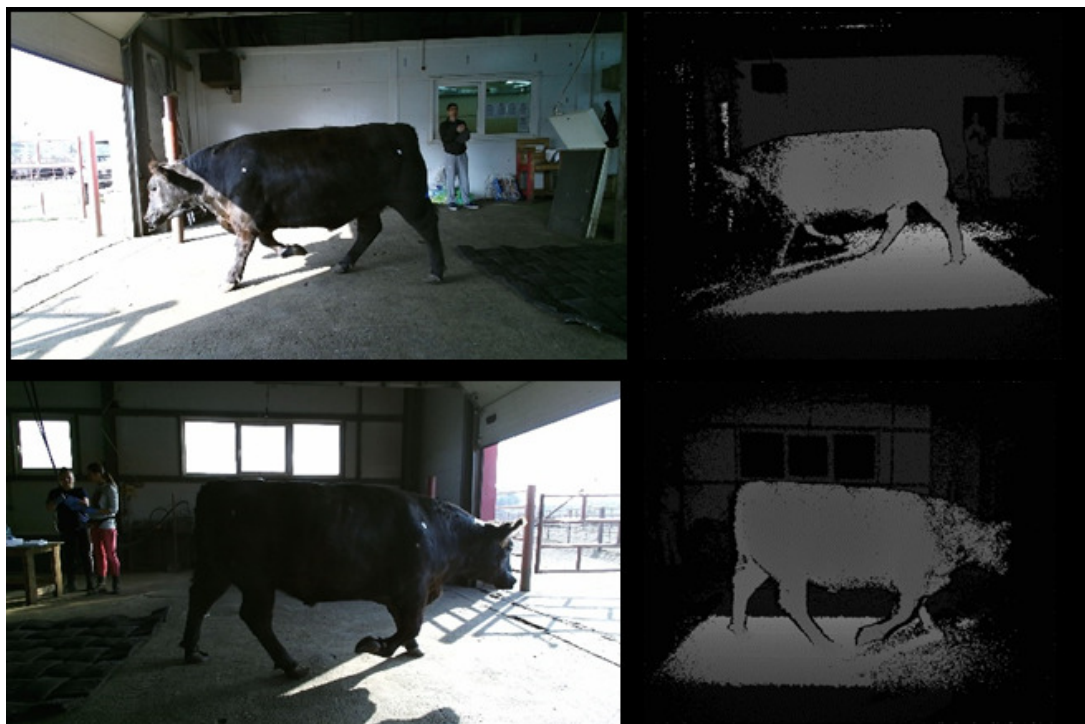
Рис. 2. RGB-изображения, карты глубины и облака точек крупного рогатого скота, снятые двумя камерами Kinect
