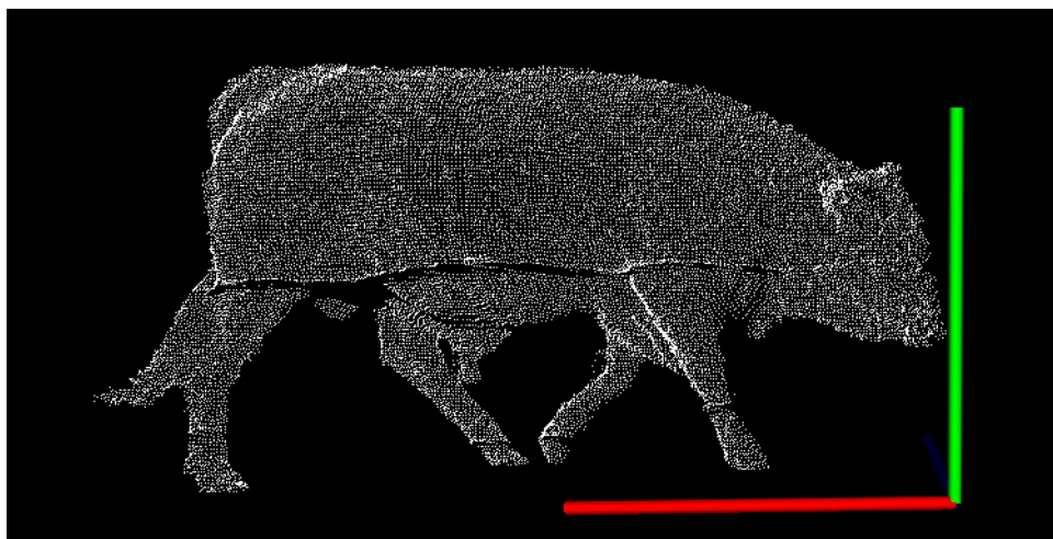
Рис. 8. Пример полученной проекции карты глубины (2.5D карта глубины)
