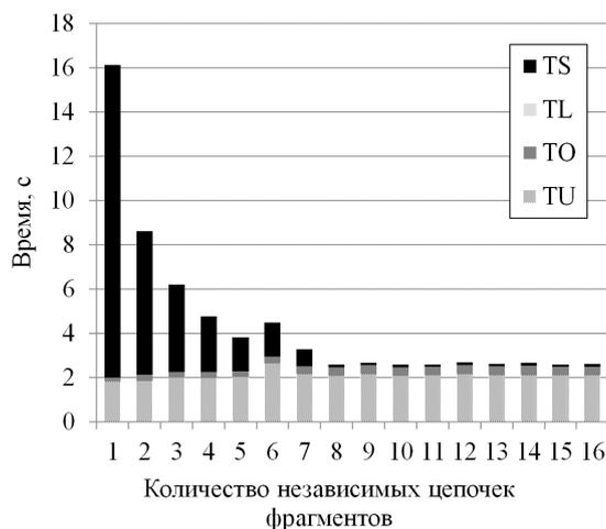
Рис. 2. Зависимость временных характеристик от степени параллелизма
