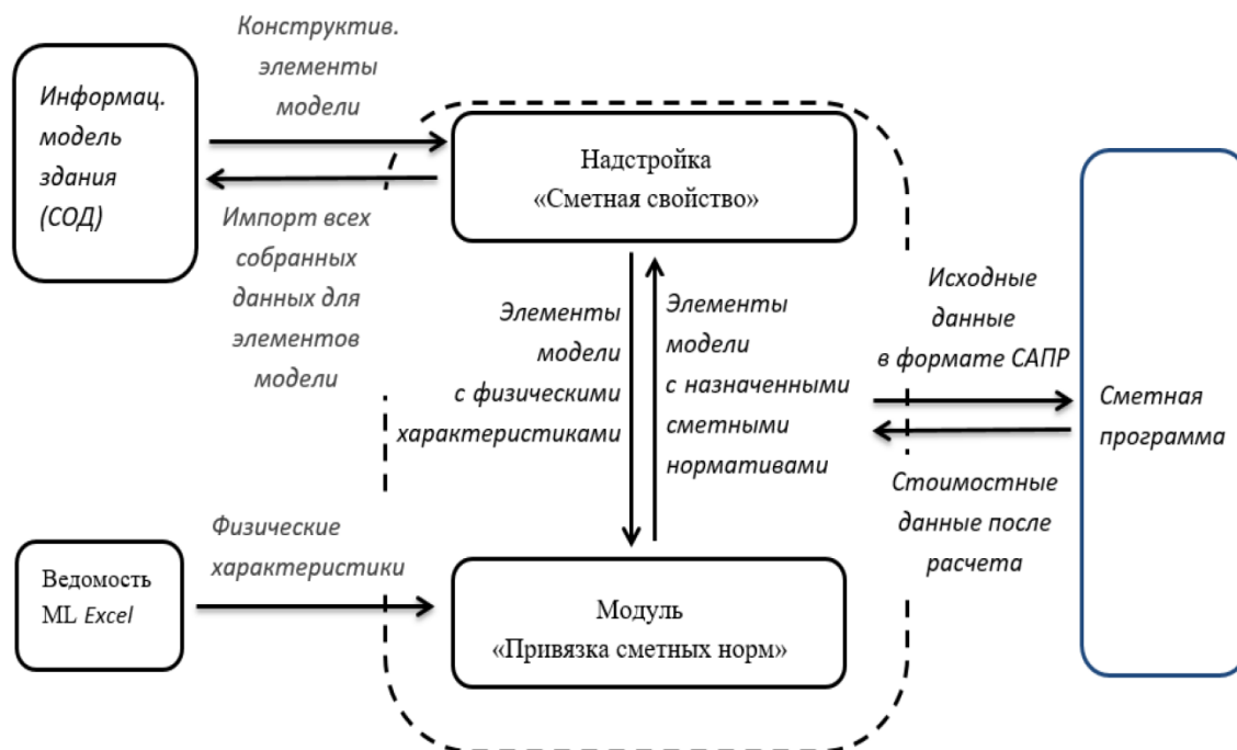
Рис. 2. Взаимодействия информационной модели со сметной программой Fig. 2. Interaction of the information model with the estimating program
