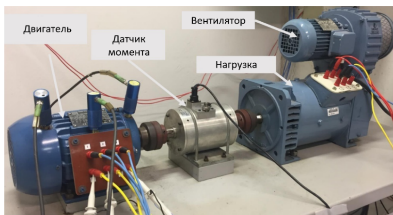
Рис. 3. Экспериментальный стенд лаборатории Сан-Паулу [24] Fig. 3. Experimental rig of the Sao Paulo laboratory [24]
