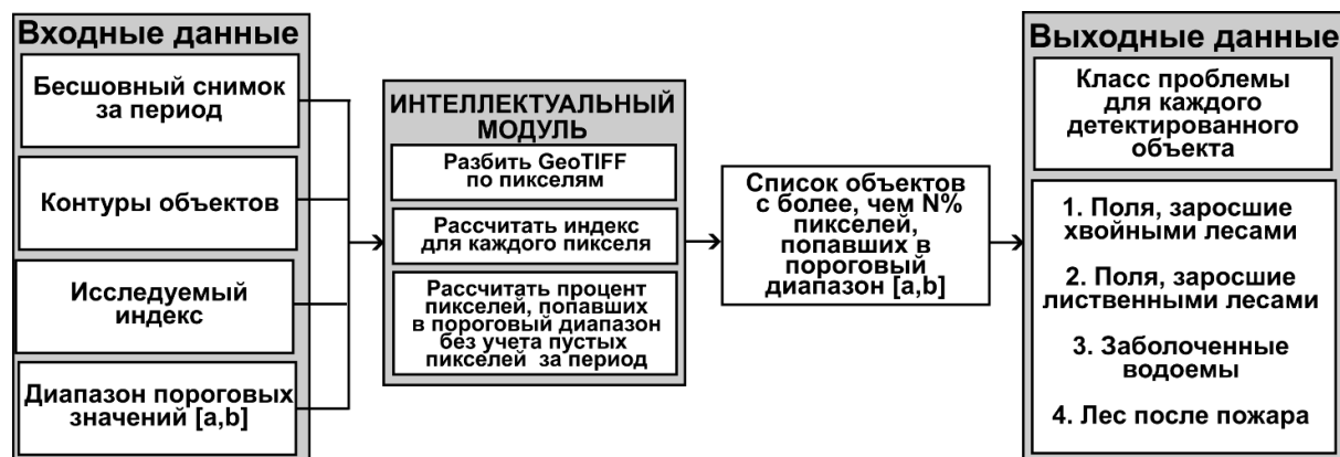
Структура интеллектуального модуля для детекции проблемных объектов природопользования The structure of an intelligent module for detecting problematic environmental management objects
