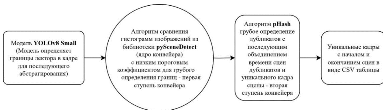
Рис. 2. Алгоритм разграничения сцен для видеолекции «Лектор и презентация» Fig. 2. Scene segmentation algorithm for the “Lecturer and presentation” video lecture
