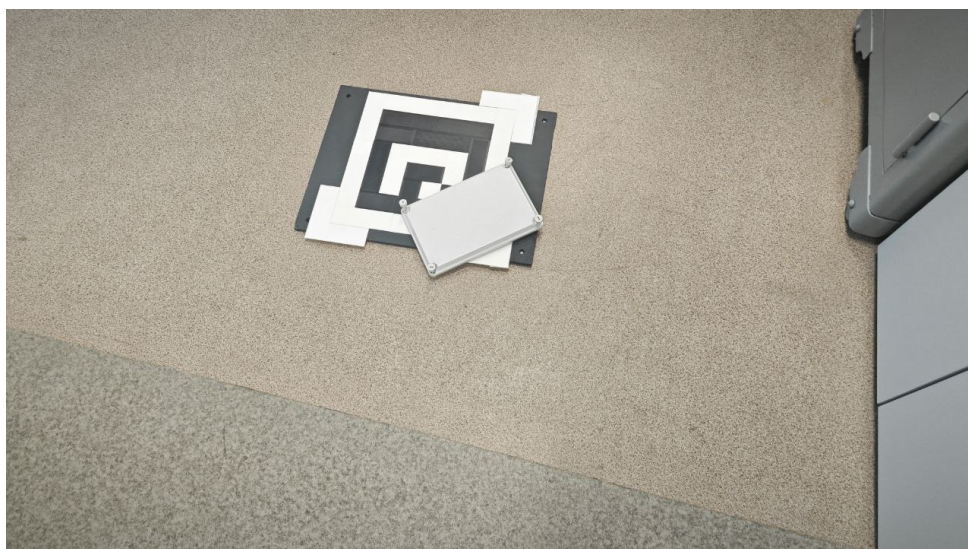
Рис. 9. Пример маркера с перекрытием ключевой точки Fig. 9. An example of a marker with a keypoint overlap
