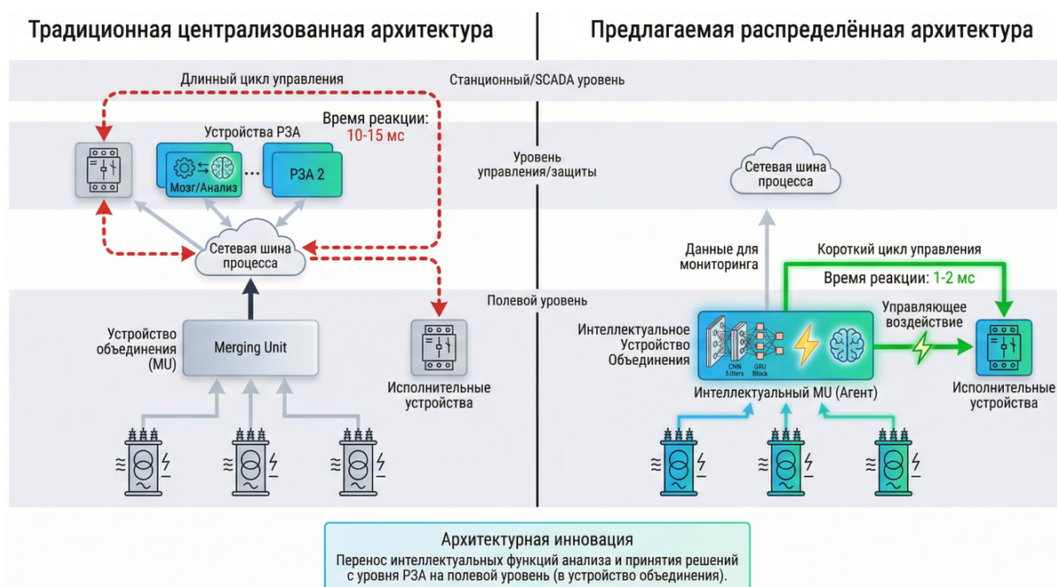
Рис. 1. Сравнение вариантов организации управления цифровой подстанцией Fig. 1. Comparison of options for organizing digital substation control
