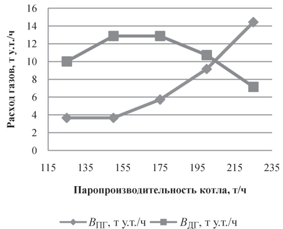
Рис. 4. Диаграмма работы котла № 7 ТП-200 ЦЭС ОАО «ММК» при совместном сжигании природного и доменного газов
