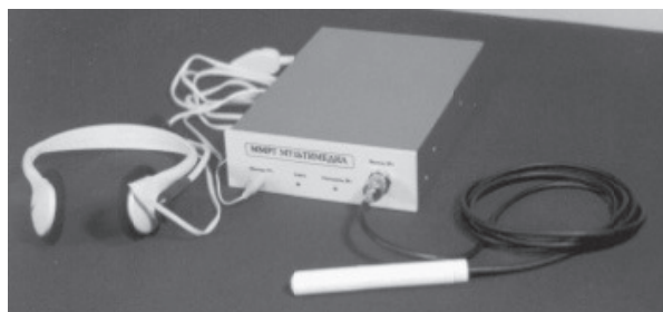
Рис. 8. Внешний вид модульной конструкции с используемыми в процессе лечения аксессуарами: антенна, стереонаушники
