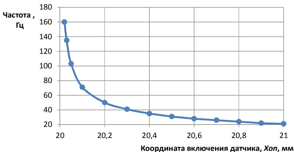
Рис. 6. Расчетное изменение частоты пульсаций ПМ от координаты включения датчика при  $X_{\text{off}} = 20$  мм,  $m = 5,57$  г
