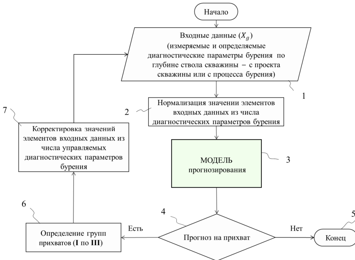
Рис. 3. Алгоритм прогнозирования прихвата технологического инструмента по глубине ствола скважины [14]
