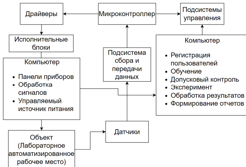
Рис. 6. Структурно-функциональная схема реально-виртуальной лаборатории с реальными объектами и виртуальными приборами Fig. 6. Structural and functional diagram of a real-virtual laboratory with real objects and virtual devices
