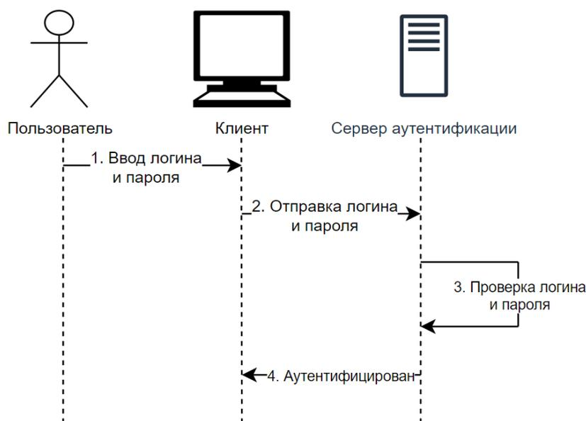
Рис. 1. Схема аутентификации на основе многоразового пароля
