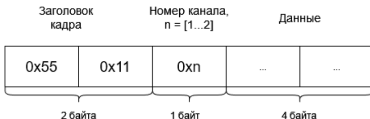
Рис. 3. Формат передаваемого кадра Fig. 3. The format of the transmitted frame
