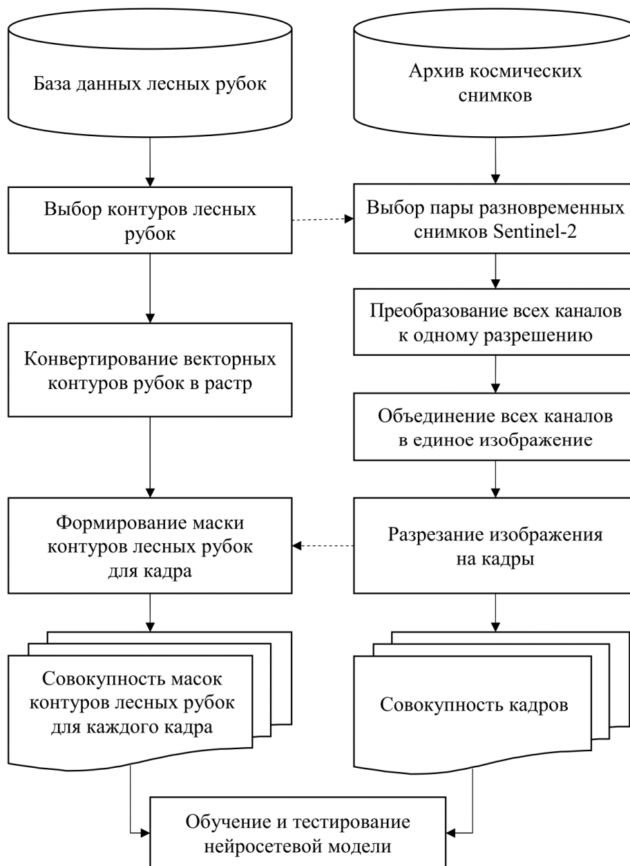
Рис. 2. Схема формирования набора обучающих данных Fig. 2. Scheme for generating a set of training data
