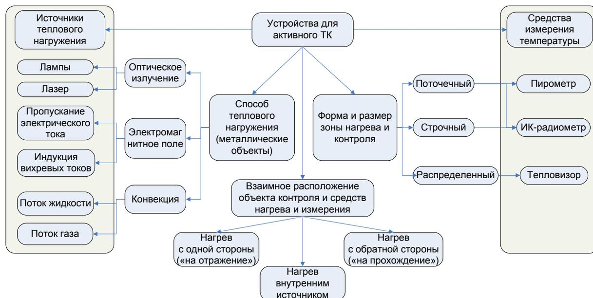
Рис. 1. Способы проведения активного теплового контроля
