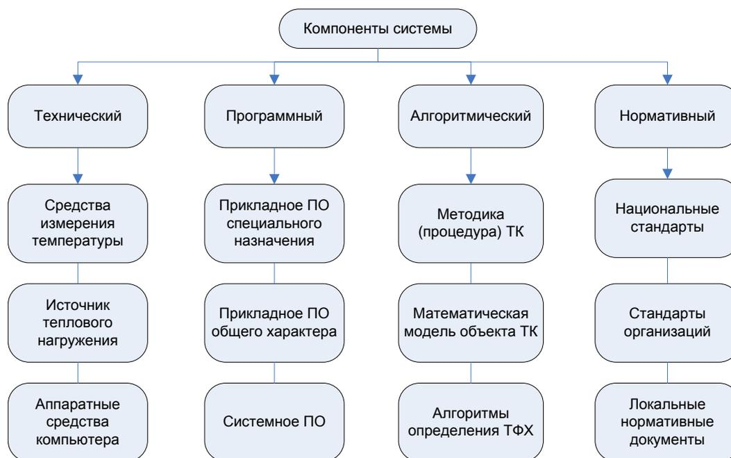
Рис. 2. Состав системы контроля качества, базирующейся на использовании методов теплового неразрушающего контроля
