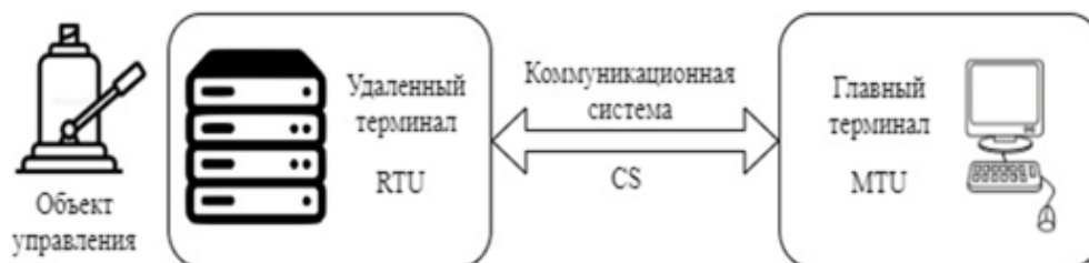
Рис. 3. Компоненты SCADA-системы Fig. 3. SCADA components
