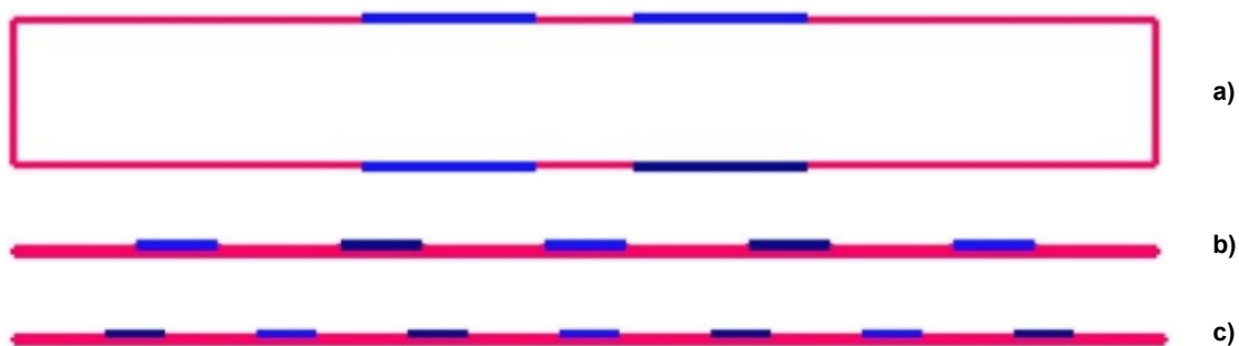
Рис. 5. Поперечные сечения двухслойной структуры (а), с крайними сигнальными проводниками (б) и с крайними опорными проводниками (с) в системе TALGAT Fig. 5. Cross sections of the double-layer structure (a), with outermost signal conductors (b) and with outermost ground conductors (c) in the TALGAT system
