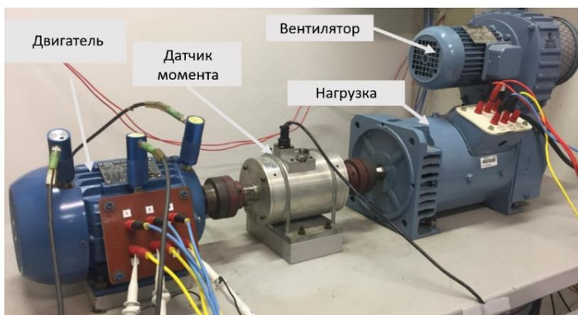
Рис. 3. Экспериментальный стенд лаборатории Сан-Паулу [24]
