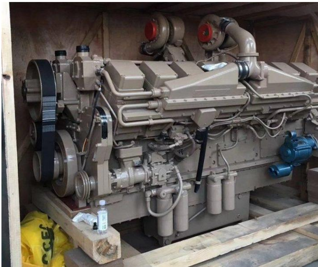
Рис. 3. Дизельный двигатель Cummins QSK-60-C Fig. 3. Diesel engine Cummins QSK-60-C
