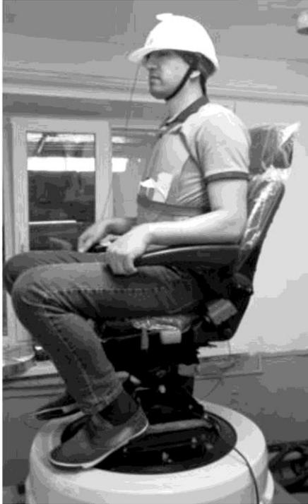
Рис. 3. Испытатель на виброзащитном сиденье на вибростенде
