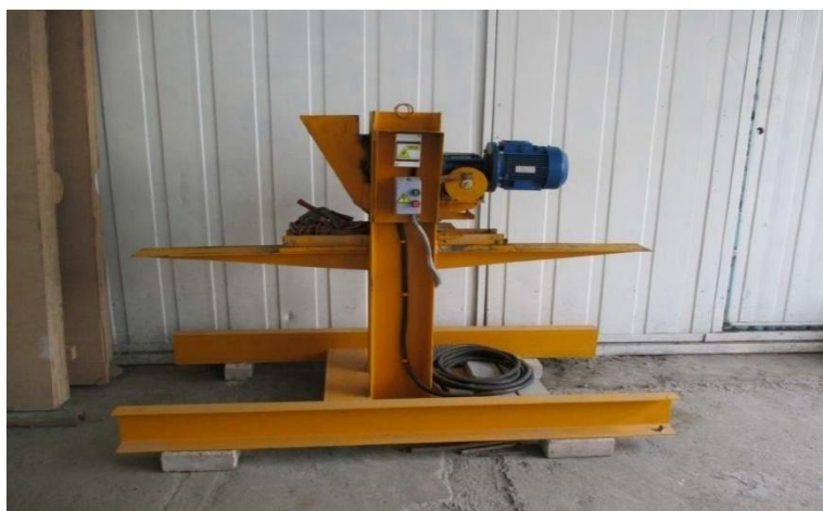
Рис. 15. Машина для уплотнения трудно деформируемых (жестких) бетонных смесей Fig. 15. A machine for compacting rigid concrete mixtures
