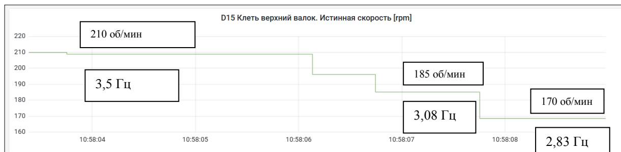
Рис. 12. Частота вращения рабочего вала Fig. 12. The speed of rotation of the working roller
