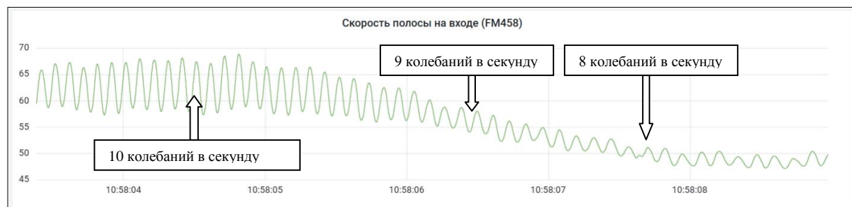
Рис. 13. Скорость полосы на входе, м/мин Fig. 13. The speed of the strip at the entrance
