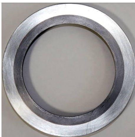
Рис. 6. Сборочная единица с паяным соединением Fig. 6. Assembly unit with a solder joint
