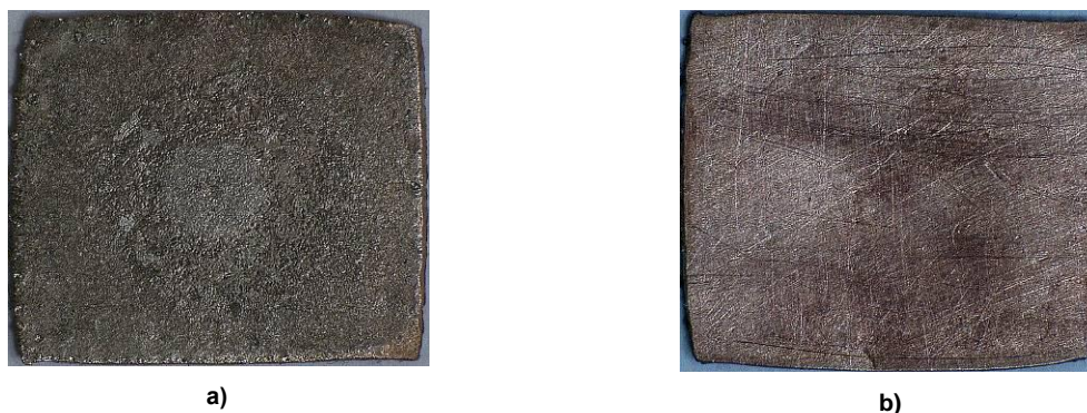
Рис. 2. Образец меди толщиной 0,6 мм после расплавления припоя: а – вид со стороны припоя; б – вид с обратной стороны
