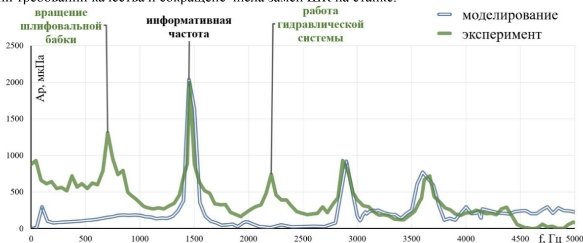
Рис. 4. Сравнение частотных составов акустических сигналов шлифования, полученных моделированием и экспериментально
