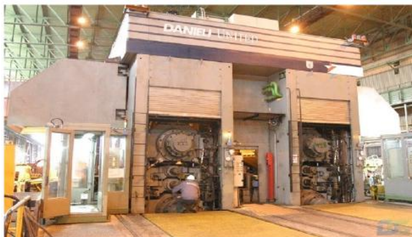
Рис. 1. Двухклетевой реверсивный стан холодной прокатки Fig. 1. Two-cell reversible cold rolling mill
