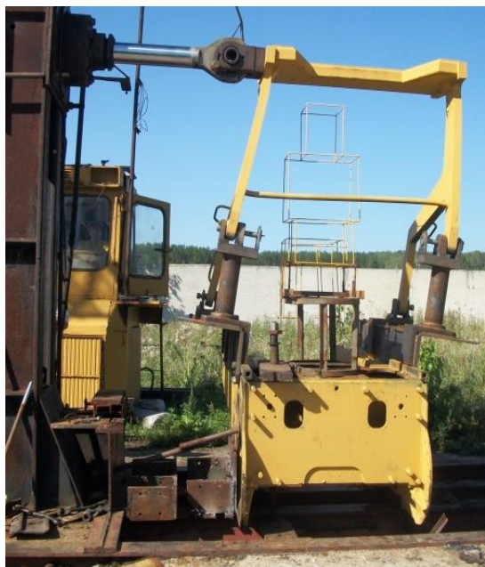
Рис. 1. Испытания защитного устройства ROPS при боковом нагружении
