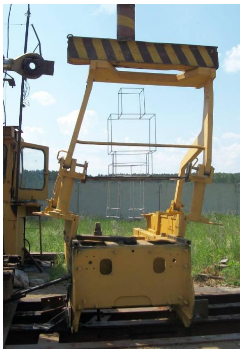
Рис. 6. Нагружение вертикальной нагрузкой усиленного ROPS Fig. 6. Loading the reinforced ROPS structure with a vertical load
