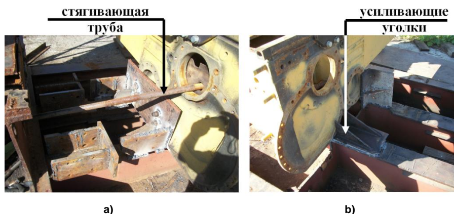
Рис. 4. Увеличение жесткости крепления ROPS с помощью (а) стяжки и (б) уголков Fig. 4. Increasing the rigidity of the ROPS fastening using (a) tie rods and (b) angles
