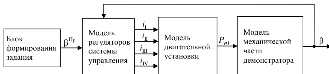
Рис. 6. Структурная схема полной модели системы управления вертикальным перемещением демонстратора Fig. 6. Block diagram of the complete model of the control system vertical movement of the Demonstrator
