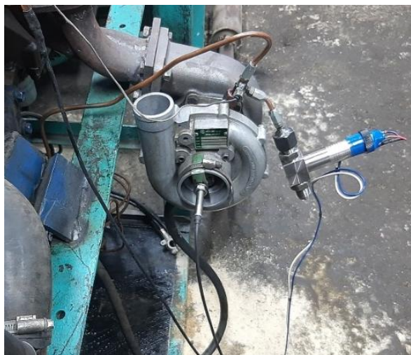
Рис. 3. Используемые датчики для комплексного контроля рабочих параметров масла
