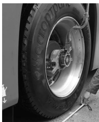
Рис. 6. Тензометрические измерительные колёса Kistler RoadDyn и система сбора данных IMC-CRFX-400 Fig. 6. Kistler Roading Strain Gauge Wheels and IMC-CRFX-400 Data Acquisition System
