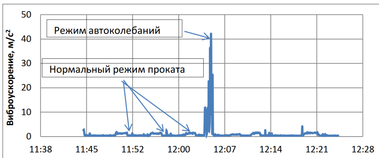
Рис. 5. Момент возникновения автоколебаний на подшипниках ролика натяжной станции травильного агрегата. Амплитуда виброускорения 42 м/с 2
